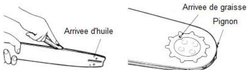
Vérification: Inversez la barre de temps en temps pour éviter les effets de l'usure. Le rail du bar devra toujours être en place. Utilisez une règle pour l'observer. Si un écart est observé entre eux,
