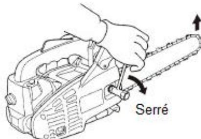
Tout en soulevant le guide chaîne, tournez le vis du teneur pour appliquer une tension correcte a la chaîne. Ensuite bloquez les écrous du carter.
