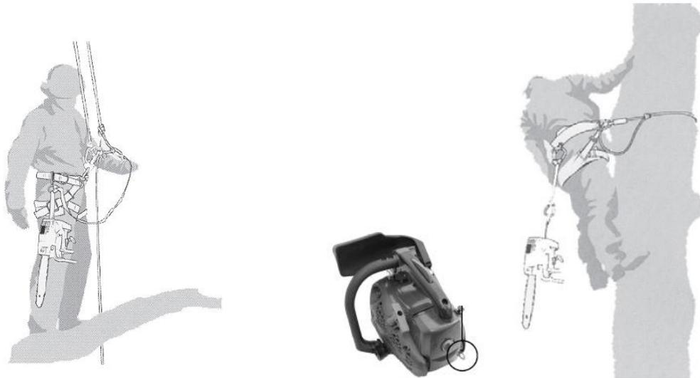
La possibilité de fixer directement la scie au harnais réduit le risque de dommages à l'équipement lors d'un déplacement autour de l'arbre. La scie doit toujours être éteinte lorsqu'elle est directement fixée au harnais.
