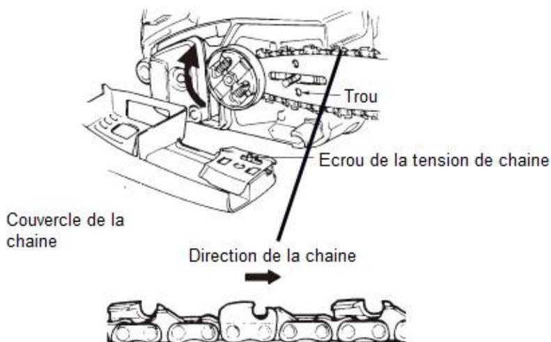
6. Ajustez l'écrou de mise sous tension de la chaîne dans le trou inférieur du guide. Installez ensuite le carter de la chaîne et fixez l'écrou de montage et enfin vissez la vis hexagonale.
