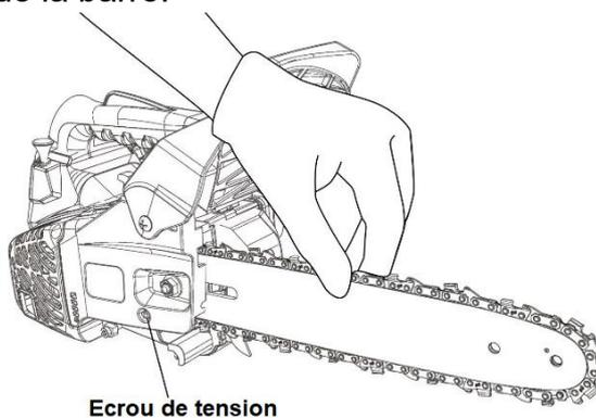
8. Serrez les écrous et vérifiez si la chaîne à une rotation correcte et elle est bien tendue.
