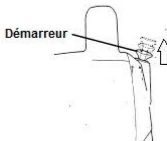
d. Tenez fermement la scie à chaîne plaquée au sol. Mettez la scie à chaîne:
