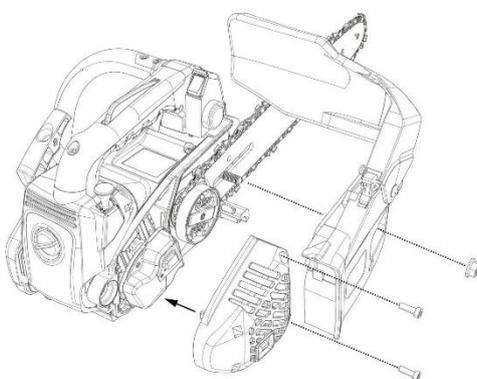
7. Réglez la tension de chaîne en tournant la vis de tension jusqu'à ce que les courroies d'attache touchent juste le côté bas de la barre.
